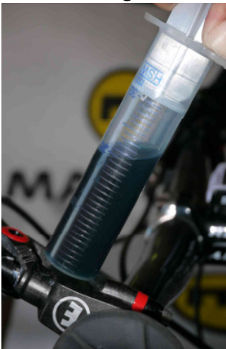
Abschliessend ziehen Sie die Spritze über die Bohrung. Damit wird das System drucklos. Halten Sie nun die Bohrung mit dem Finger geschlossen und ziehen die Spritze ab.
