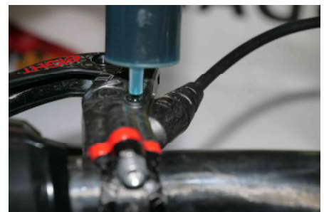
Pressen Sie die Spritze in die EBT Öffnung
