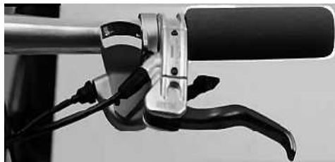
Тормозная ручка и главный тормозной цилиндр Magura Marta®
