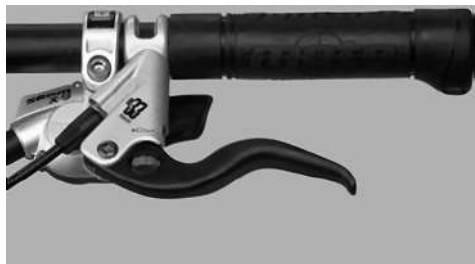
Тормозная ручка и главный тормозной цилиндр Magura HS33
