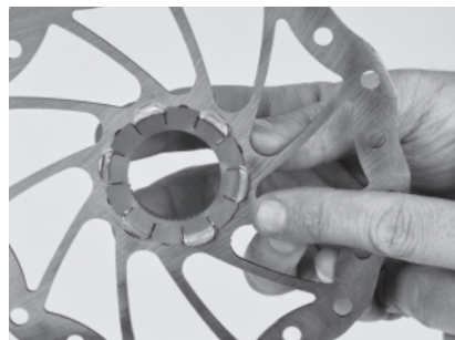
2. Mounted lock washer. 2. Rondelle de blocage montée.
