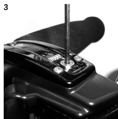
2.+ 3. Bremsgriff WAAGRECHT positionieren. Alle Schrauben des Ausgleichsbehälterdeckel lösen.
