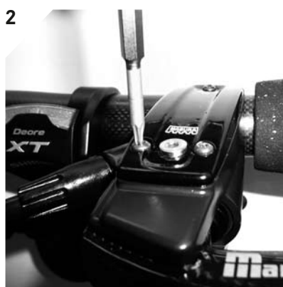
2.+ 3. Bremsgriff WAAGRECHT positionieren. Alle Schrauben des Ausgleichsbehälterdeckel lösen.
