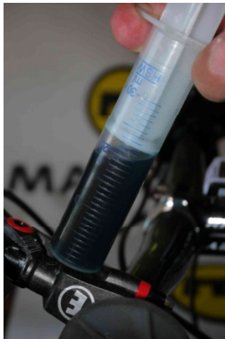
Ziehen Sie die Spritze nun bis zur Anzeige 30 auf der Skala, unterhalb der Bohrung, drücken Sie nun das Öl in den Bremsgriff. Wiederholen Sie dies 3-4mal.
