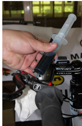
Abschliessend ziehen Sie die Spritze über die Bohrung. Damit wird das System drucklos. Halten Sie nun die Bohrung mit dem Finger geschlossen und ziehen die Spritze ab.
