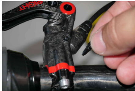
Entfernen Sie mit einem T25 Schlüssel die EBT Schraube
